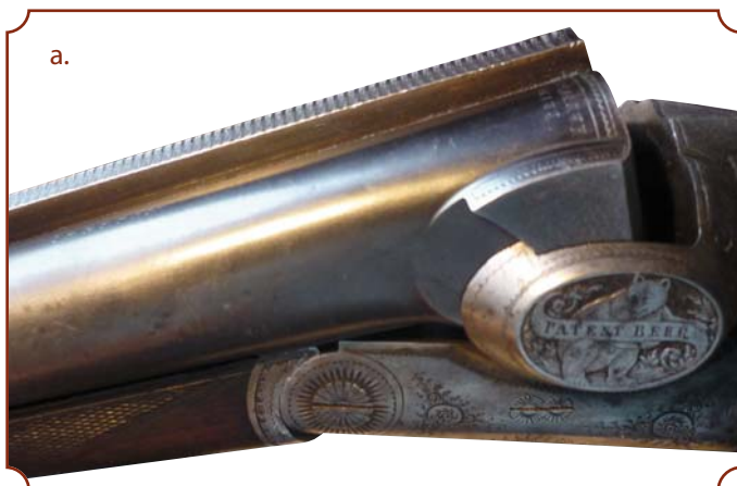
Илл. 12. Боковая разгружающая опора в приливе плечиков коробки ружья Б. Бэра (BP № 15216, 1906)
