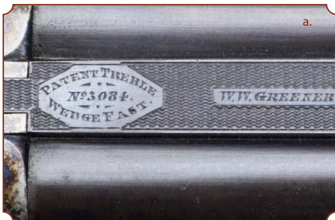
Илл. 7. Надпись на прицельной планке ружья Гринера гласит: Treble Wedge Fast, т. е. «Тройной клиновидный затвор», более известный в России как «тройной затвор Гринера»
