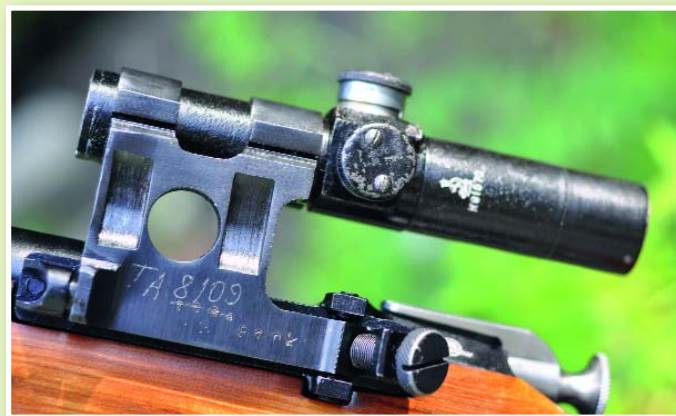
Кронштейн Кочетова-Сулимова. Модифицированный кронштейн является наиболее удобным способом качественного улучшения прицельного комплекса на «мосинке», имеющей стандартное основание кронштейна Кочетова
