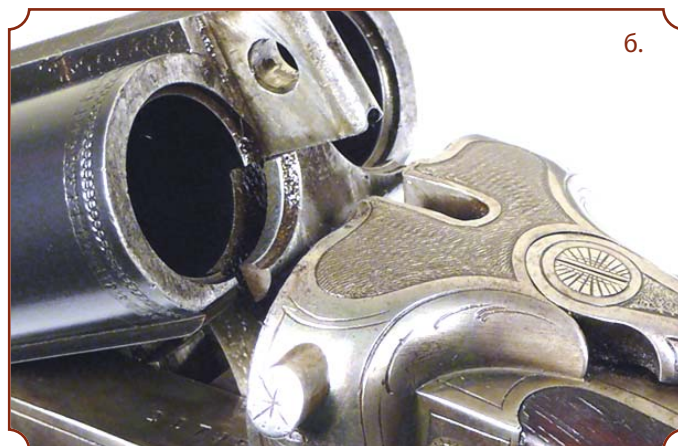
Илл. 7. Надпись на прицельной планке ружья Гринера гласит: Treble Wedge Fast, т. е. «Тройной клиновидный затвор», более известный в России как «тройной затвор Гринера»
