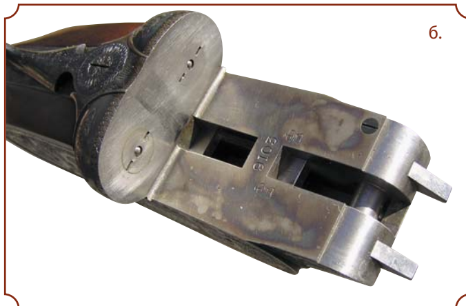
Илл. 4. Двузаходная планка (рамка) Пёрде обеспечивает надёжное запирающее и нарезного (а), и гладкоствольного (б) оружия
